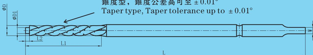
★ 刀口結構可以任意的排屑方式(如,上排屑、下排屑、左旋右切、右旋左切、左旋左切,右旋右切等等。高螺旋刃,低螺旋刃,帶導柱不帶導柱等等,結構形狀之方式。
