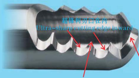
外刀：環周外徑外側采用CNC超硬砂輪 $20^{\circ}$  -  $70^{\circ}$  角度（依鋒利要求）之超硬精研磨（刃口處于內徑內側處）。
